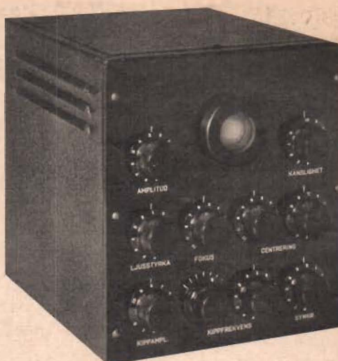
Katodstråleoscillografen är ett värdefullt hjälpmedel för den mera försigkomne amatören. Den här visade modellen har inbyggda förstärkare för horisontell och vertikal avlänkning. (Beskriven i nr 1, 1938.)
