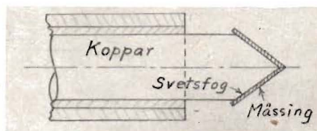
Fig. 2. Hur lödkolven förbättras genom påsvetsning av ett mäs-singsbleck på kopparspetsen.
