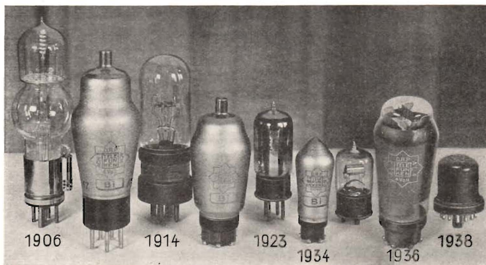
Fig. 1. Elektronrörets utvecklingskedja. Till vänster: kvicksilverångfylld rör (Liebenröret 1906), främre raden: nyare rör (1934 till 1938), till höger: stölrör.
