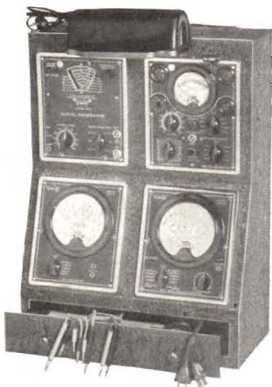
Fig. 8. Ett flertal typer av kompletta servicepaneler finnas numera i marknaden. Exemplet ovan har överst en serviceoscillator och en »bad-good»-rörprovare samt underst en växelspänningsvoltmeter och en volt-milliamper-ohm-meter. (Triplett.)
