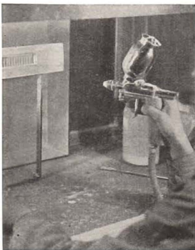
Fig. 14. Besprutning av de små rörkatoderna.
