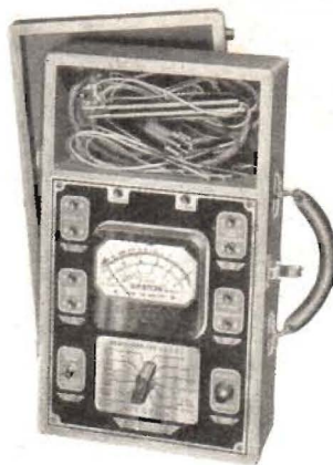
Fig. 5. Ett modernt, lätt bärbart universalinstrument, speciellt avsett för radioservice. Ohm-per-volt-talet uppgår för likspänning till 20 000, varför instrumentets egenförbrukning i de flesta fall är försumbar. (Weston, modell 772.)
