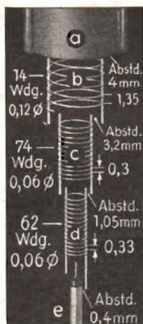
Fig. 17. Elektrodernas dimensioner och inbördes avstånd hos en högfrekvenspentod (AF7). a: anod, b: bromsgaller, c: skärmgaller, d: styrgaller, e: katod.
