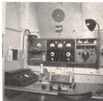
Fig. 9. En praktisk mätbörna i en modern serviceverkstad. På panelen finnas de vanligaste serviceinstrumenten, till vänster om denna synes en rörvoltmeter och till höger en serviceoscillator. Rörprovaren har placerats på bänken och provhögtalaren upptill på väggen. (Luxor.)
