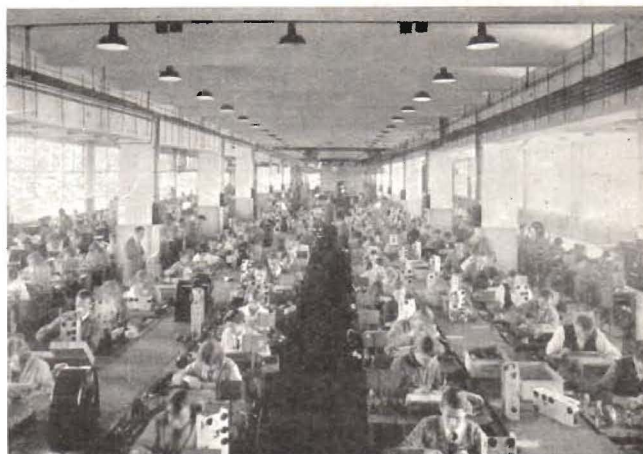
Fig. 7. En av monteringshallarna för rundradiomottagare. Delarna transporteras på löpande band. Under arbetet bjuds på musikunderhållning via högtalare, ej synliga på bilden.
