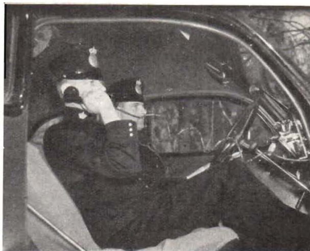
Radiobilens förarsäte. Man ser mikrotelefonens klyka på instrumentbrädan.
