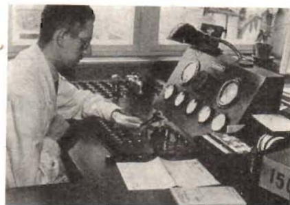
Fig. 12. Rörprovning är ofrånkomlig vid all radioservice. Vid större serviceföretag rationaliseras rörprovningen, så att en man har jämnt arbete enbart med denna detalj. Härövan undersöks ett rör med avseende på mikrofoneffekten. (Telefunken.)
