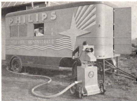
Fig. 6. Här är man i färd med att televisera ett sportevenemang utanför Eindhoven. I förgrunden ses televisionskameran.
