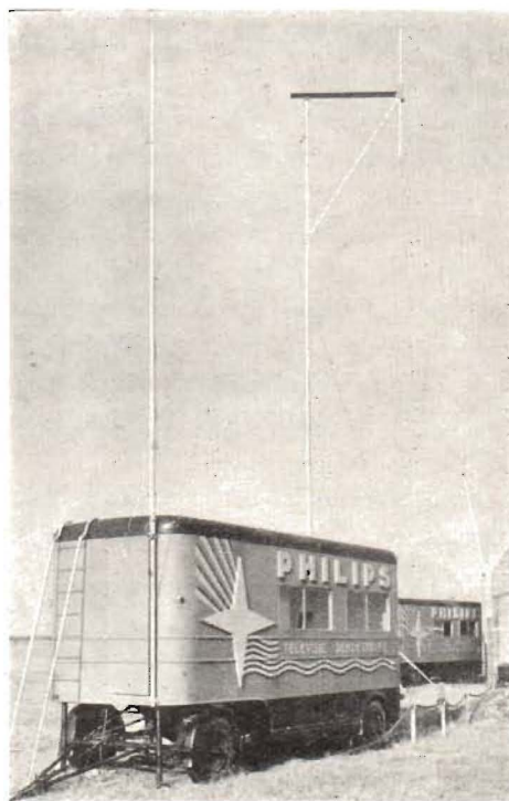
Fig. 5. Televisionsvagnarna med den vertikala dipolantennen synlig högst uppe i masttoppen.
