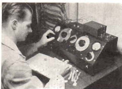
Fig. 13. Vid radioservice har man i regel ej tillgång till ett så dyrbart instrument som en Q-meter, ehuru en dylik skulle utgöra ett värdefullt plus till apparaturen. Ovan synes en Q-meter i användning på ett radiolaboratorium. (Centrum-Radio.)
