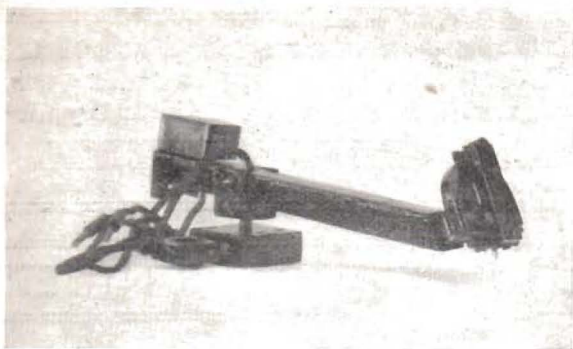
Fig. 6. Nålmikrofonen med arm, lageranordning och anslutnings-sladd. Arm och lagerplatta av trä. Magneten är tung, varför en av bly gjuten motvikt använts, som nedbringar nåltrycket till ca 60 gram. Spolens anslutningsstrådar ha lagts i en ränna på armens undersida samt förts upp genom ett hål vid lagret. Om lång fästskruv för nålen användes, är det bra att, som framgår av bilden, fästa en bakelitbit el. dyl. på nålmikrofonen samt låta skruven gå genom ett hål i denna. Hålens diam. bör vara något större än skruvens, så att ankarets rörelse ej hindras. Därigenom skyddas ankaret vid nålbyte, samt om man skulle stöta emot skruven. Nålmikrofonen skall snedställas i förhållande till tonarmen, så att nålplanet skärning med grammojonskivan blir tangent till spåret i skivan. (Jämför de moderna kommersiella nålmikrofonerna.)
