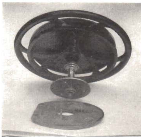
Fig. 4. Denna bild visar skivtallrikshjulet från undersidan. Remskivan befinns sig omedelbart under hjulkranen. Cykelnavet med dess metallskiva B samt tråkskivan C liggande på bordet kunna vidare iakttagas. (Jämför med fig. 5.)
