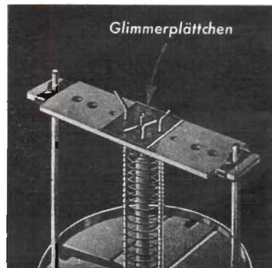
Fig. 33. Glimmerhållaren påsatt. Säkerställer avståndet katod—styrgaller.
