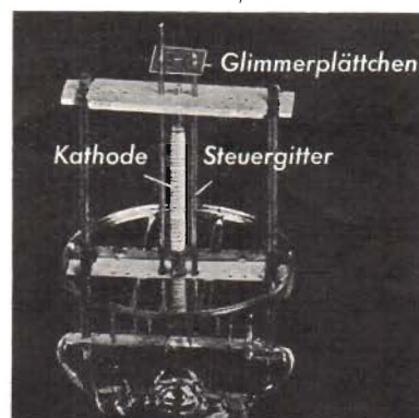
Fig. 32. Det s. k. taklucksglimret för noggrann centrering av katoden. (Steuergitter = styrgaller.)
