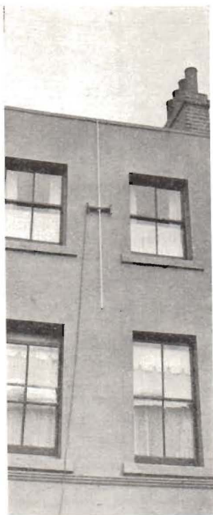
Fig. 13. Om en televisionsmottagare skall giva valuta för pengarna, måste antennenläggningen ägnas stor omsorg. Övan en provdipol, som kan hängas upp litet varstans för undersökning av fältstyrkeförhållandena på platsen för en installation.
