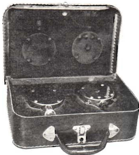
Fig. 3. Väska för förvaring och transport av kristallmikrofoner, in-vändigt klädd med plysch. Plattan, på vilken mikrofonerna ligga, är uppfällbar, och under densamma finns tillräckligt utrymme för ledningarna.
