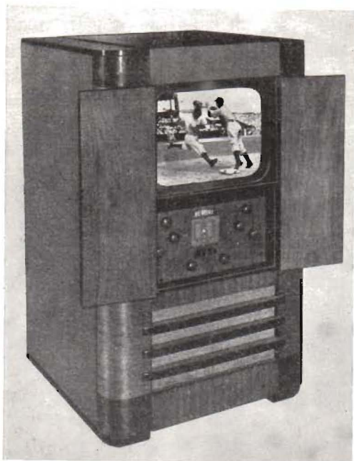
Fig. 8. Du Mont, modell 195 X med 15"×11 3/4" bild; en representant för mottagartypen med direkt bild. Speciellt inom den lägre prisklassen börja dessa mottagare komma allt mer till synes, sedan amerikanerna efter europeiskt mönster lärt sig bygga korta bildrör med stor skärmdiameter. Även denna modell har tryckknapps-avstämning rundradiomottagare.
