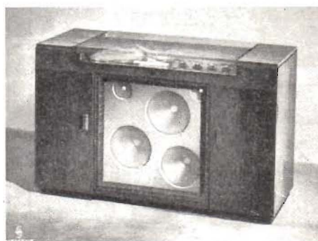
Fig. 4. Denna bild visar placeringen av högtalarna i Siemens' konserttradio, modell KMG IV, vars verkliga exteriör framgår av vinfjettbilden.
