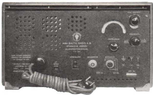
Fig. 7. Allströmsförstärkaren från baksidan. Inställningsanordningarna för radiomottagaren äro samlade upptill till höger. Omkopplarna för olika nätspänningar samt olika utgångsimpedanser äro åtkomliga sedan bakluckan lossats. Mikrofonuttaget är balanserat, medan gramfonuttaget är försett med vanlig enpolig anslutning.
