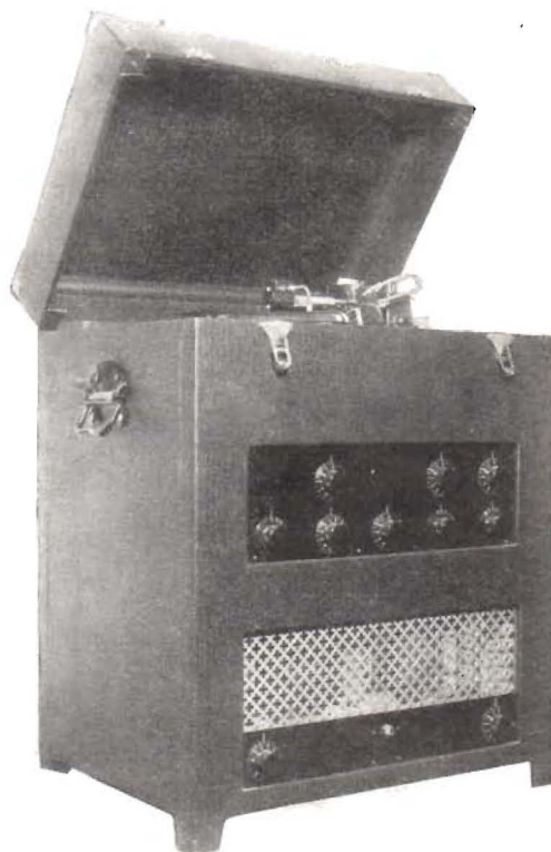
Fig. 1. Denna bild visar förf:s inspelningskoffert. Längst ner står slutförstärkaren. Ovanför denna chassiet med mikrofonförstärkare, »mixer» och korrektionsanordning. Under det uppfällda locket ses graverapparaten. På koffertens baksida finnes en lucka för ledningar från mikrofoner m. m.
