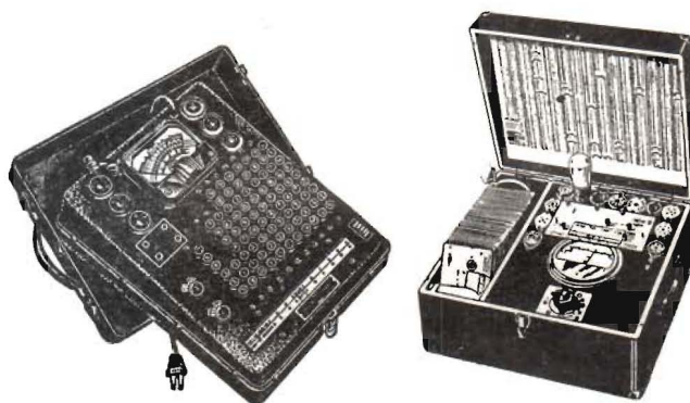
Fig. 6. T. v. en amerikansk »kassaregisterprovare» med tryckknappsväljare, som betjänas i enlighet med en medföljande tabell. T. h. en europeisk rörprovare av den typ, som användes i förbindelse med perforerade kort. Dessa placeras över spänningsväljaren på panelen, och genom att sticka proppar i hålen, läggas automatiskt vissa normerade spänningar på rätta rörpoler.
