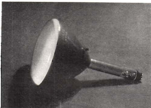
Fig. 3. Philips-bildrör av modernaste typ, MV 22-1, med liten längd (35 cm) och stor skärmdiameter (22 cm). Såväl avlänkning som fokusering sker elektromagnetiskt, ehuru viss fokusering även erhålles elektrostatisch.
