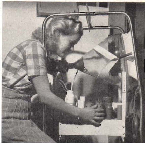
En demonstrationsmottagare från höstens Olympia-utställning i London. Bland intressanta detaljer lägger man märke till upphängningssystemet för bildröret. (Foto: His Masters' Voice.)
