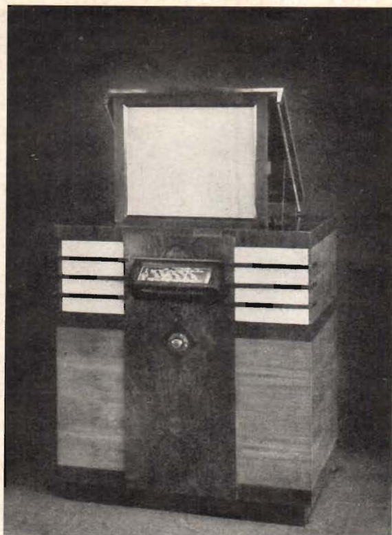
Fig. 10. Mottagare av golvmodell — Philips' stora projektmottagare för television och radio. Bildstorlek 45×36 cm. Projektionsröret är av relativt små dimensioner, men det arbetar med en anodspänning om 25 000 volt, varför ljusstyrkan på skärmen blir så stor, att bildprojektion möjliggöres.
