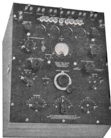
Fig. 3. Rörmütbrygga av amerikanskt fabrikat, speciellt avsedd för fabriker, skolor och vetenskapliga laboratorier. Bryggan, som är mycket dyrbar — den kostar omkr. 1 000 kronor — medger synnerligen noggranna mätningar på alla slags rör (General Radio Co.)
