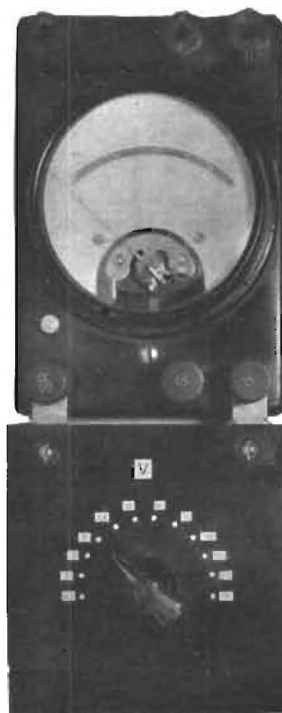
Fig. 2. Mavometern med universalförkopplingen ansluten.
