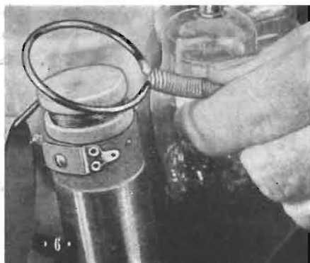
Fig. 2. Uppmätning av en högfrekvensdrossels egenfrekvens.
