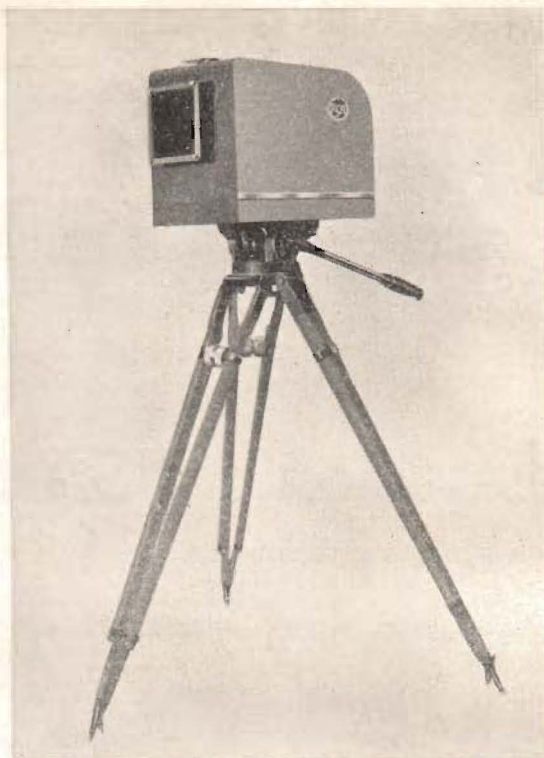
Fig. 11. En av RCA:s ikonoskopkameror för utomhusbruk. Inriktning av kameran — såväl som fokusering — sker med handtaget till höger. Denna kamera användes vid televisionsdemonstrationerna på världsutställningen i New York 1940.
