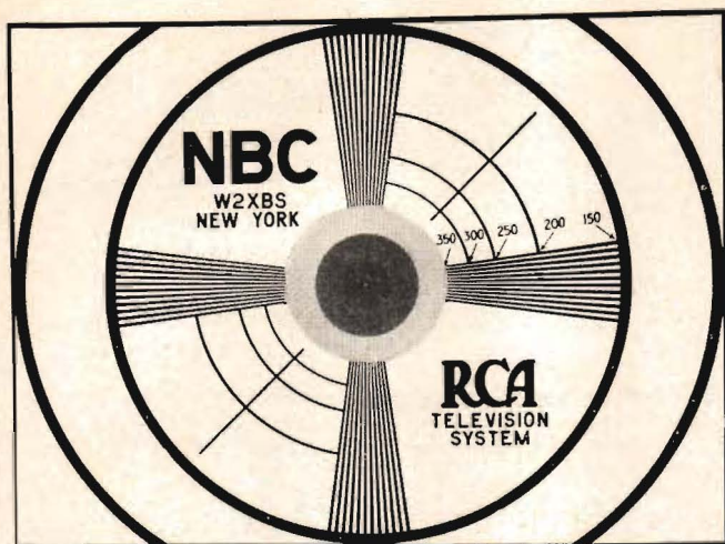
Fig. 16. RCA-NBC:s mätbild. Yttre cirkelarna angiva 4:3-formatet, cirkelytorna i centrum olika svart-vit-graden. De vertikala och horisontella strålnippena medgiva bestämning av horisontella resp. vertikala bildkvaliteten (upplösningen).
