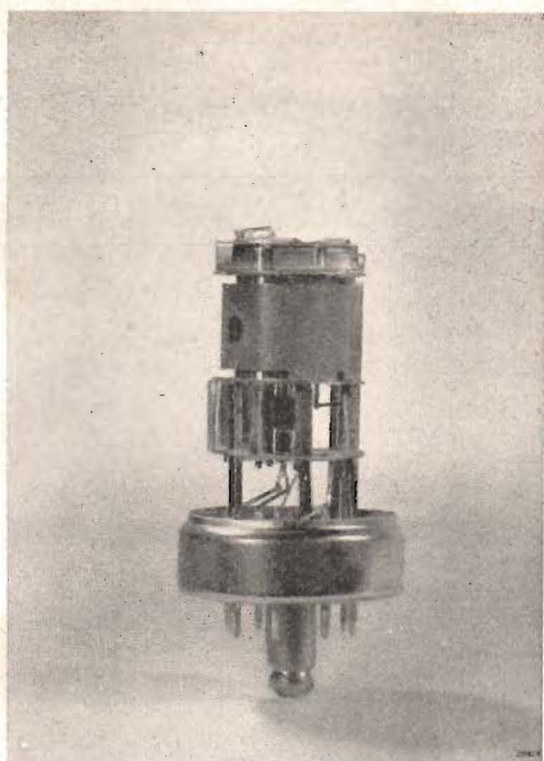
Fig. 3. Triod-heptodens ECH 21 elektrodsystem. Den omgivande metallskärmen, som synes i fig. 1, är här avlägsnad.
