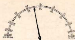
Fig. 3. Den direktvisande tonfrekvensmeters skala, graderad i grader.
