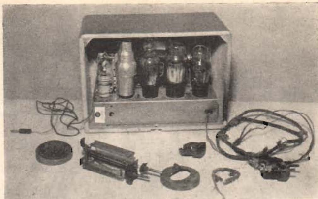
Fig. 2. Eldsvådetillbud i en apparat med i sladden inbyggt motstånd, som blivit överhettat. Ett extra seriemotstånd (t. v. framför apparaten) har också använts i detta fall. Observera den av elden svärtade lådgaveln till höger.
