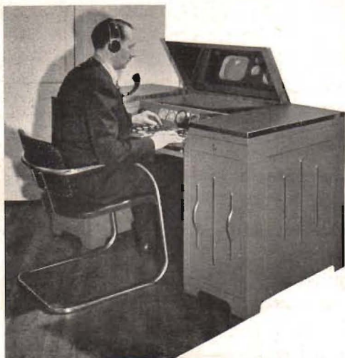
Fig. 1. Farnsworths studiokontroll för televisionssändare. Vid manöverbordet sitter Mr. W. L. Ludwick, som gjort den mekaniska delen av konstruktionen. De två bildrören äro vertikalt placerade i jacket bakom manöverbordet. Bilderna observeras via spegeln i locket.
