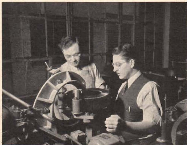
Fig. 5. I Sverige ha G. R. »Variacs» blivit allt mer uppskattade, och här se vi den speciella lindningsmaskinen i arbete på en typ 50 Variac. Maskiner som »linda runt en ring» ha funnit allt större användning inom radioindustrien.
