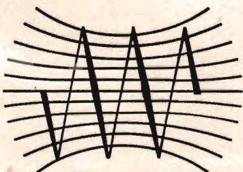
Fig. 6. Magnetfältet i en spole.
