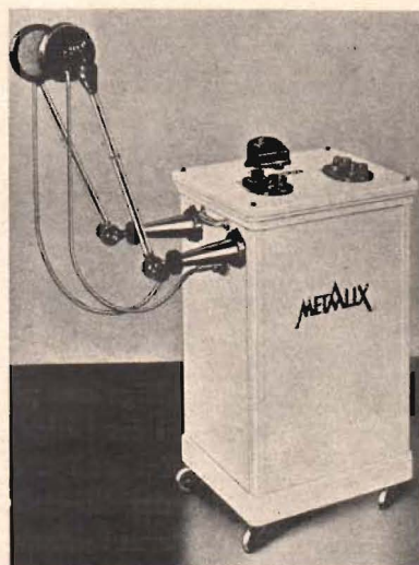
Modern ultrakortvågsterapiapparat av Philips' fabrikat. Effekten är 300 watt och våglängden 6 meter. Till vänster synes den flexibla applikatorn med de båda kondensatorelektroderna.
