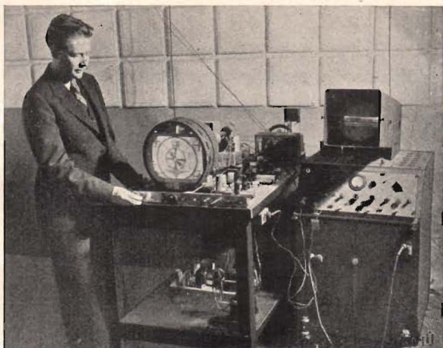
Fig. 9. Provningsutrustning för bildrör på RCA:s laboratorium i Camden. På bildskärmen syns den provbild man använder för bestämning av rörets reproduktionsförmåga. T. h. RCA:s stora laboratorieoscillograf — ett mycket användbart instrument.
