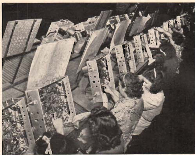
Fig. 3. Bild från en av RCA:s monteringskedjor för televisionsmottagare i Camden. Lägg märke till förbindningsschemat över varje arbetsplats. Var fjärde eller femte »man» fungerar huvudsakligen som avsynare.
