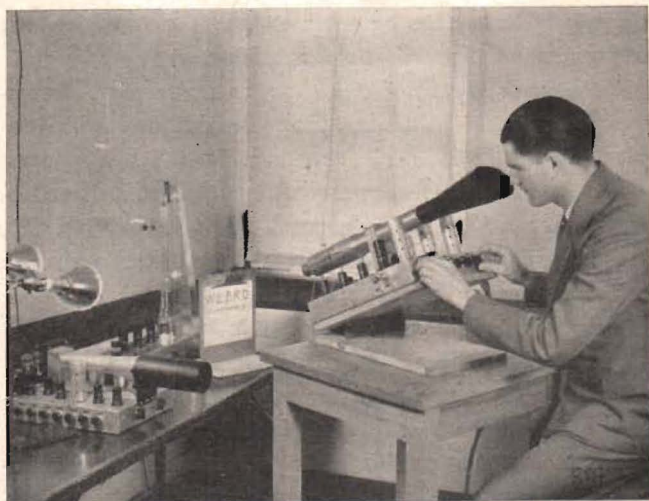
Fig. 6. RCA har byggt ett kamerarör för amatör-sändning — ett för-enklat ikonoskop. Sändaramatören å bilden har riktat in »bildkameran» på stationssignalen, W2BRO. Sändaren synes i bakgrunden med stämlinje och feeder, mottagaren till vänster på bänken.
