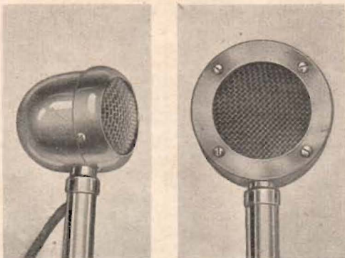
Fig. 1. Två olika yttre utföranden av den svenska kristallmikrofonen, märke »Electron». I form av mikrofonkapsel säljes den till radiofabrikerna.
