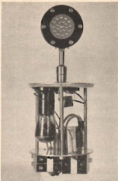
Mikrofonen sedd framifrån. Skärmburken avtagen. Vinjettbilden visar mikrofonen med påsatt skärmburk.
