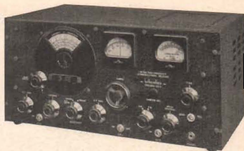
Fig. 13. AFM-trafikmottagare S27 från Hallicrafters i Chicago. Kontrollerna äro upptill: våglängdsomkopplare, avstämning, S-meterjustering (S-metern till höger upptill), tonkontroll. Nedtill: högfrekvensförstärkning, antennavstämning, MF-selektivitet, lågfrekvensförstärkning, AM-FM-omkopplare och telegrafitontkontroll.
