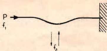
Fig. 14. Bildning av underton i mekaniskt svängningssystem.
