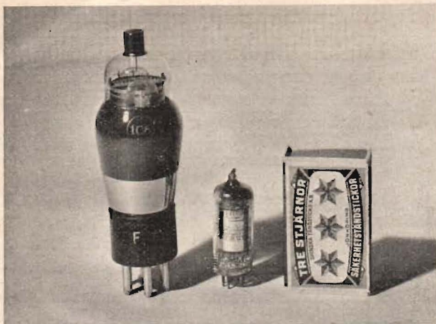
Fig. 1. Blandarrör för batterimottagare av år 1934 (1C6) och 1940 (1R5).
