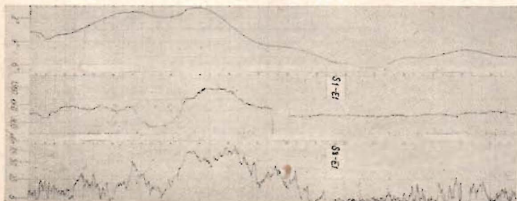
Fig. 20. Överensstämmelse mellan förloppet av fältstyrkan (nedre kurvorna) och temperaturgradienten (övre kurvan).
