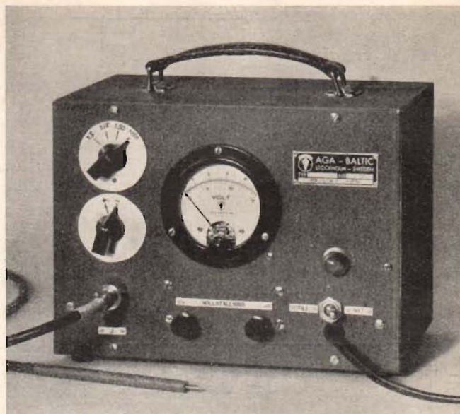
Fig. 11. Experimentmodell av likspänningsrörvoltmeter enligt schemat i fig. 10. Överst till vänster områdesomkopplaren, därunder omkopplaren plus-minus. Under instrumentet nollställningsrattarna, till höger nätströmbrytare och indikeringslampa. I testpinnen är ett stort motstånd inbyggt.
