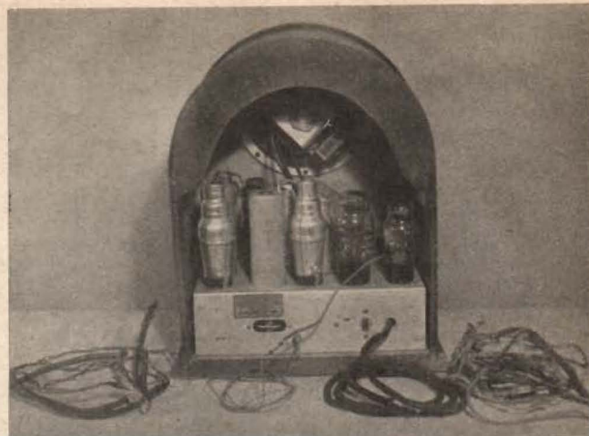
Fig. 3. En annan apparat med i nätsladden inbyggt förkopplingsmotstånd, som förorsakat eldsvåda.
