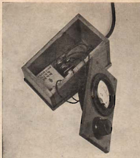
Fig. 7. Indikatorn inbygges i en låda som bilden visar. Med ratten inställes förkopplingsmotståndet från början på sitt högsta värde och minskas sedan vid behov.
