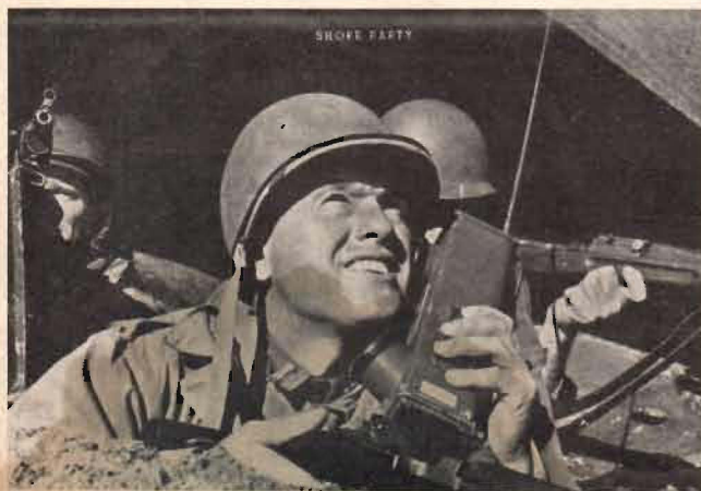
Fig. 12. Figur av amerikansk miniatyrradiostation. I »handtaget» är en komplett ultrakortvågssändare och mottagare jämte batterier inbyggd. Apparaten är utrustad med totalt fem miniatyrrör, har typbeteckningen SCR-536 och går under smeknamnet »Handie-talkie».
