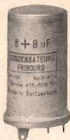
Fig. 3. Elektrolytkondensator av märket Fribourg. Torr elektrolyt.
