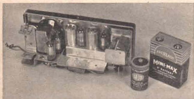
Fig. 3. RCA-VICTOR-mottagaren. Till höger ligger tvågangskondensatorn. Denna har speciellskuren oscillatorsektion och är ej större än 40×40×50 mm. Längst till vänster skymtar högtalaren, som är oval 2×3 tum, samt hållaren för 1,5-volts stavcellen.
