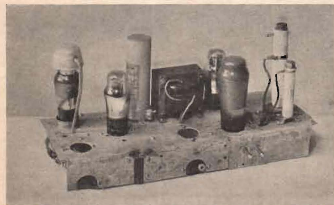
Det kompletta förstärkarchassiet. En extra rörhållare finns för att slutsteget senare skall kunna utökas till push-pull.
