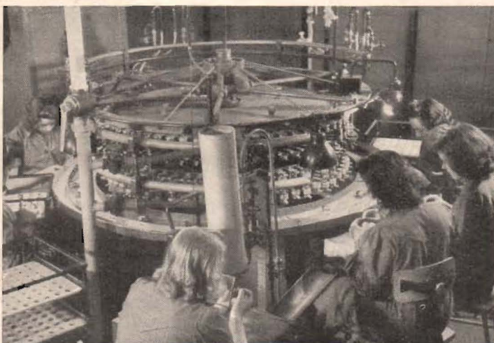
Vid "socklingskarusellen" förenas sockeln med det i övrigt färdiga röret.
