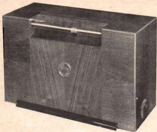
Fig. 7. FM-tillsats avsedd att möjliggöra FM-mottagning på förut befintlig AM-mottagare, varvid anslutning göres till den senares grammofonuttag. Apparaten är av Philips' fabrikat (europeisk experimentkonstruktion).
