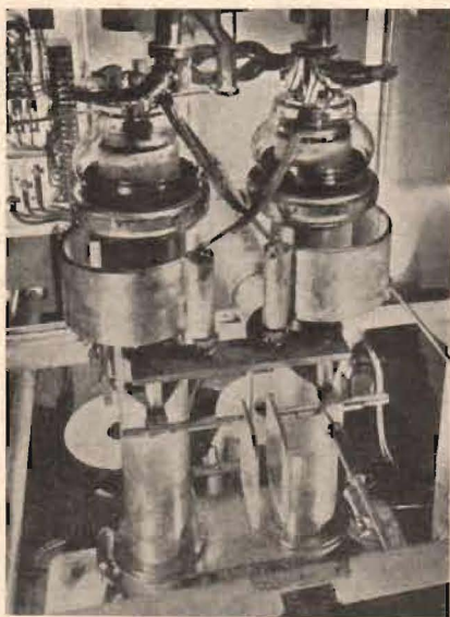
Fig. 5. Detalj till slutförstärkaren till sändaren WWZR. Vattenkylrören runt sändarrörens anoder fungera samtidigt som anodstämkräns. Slutförstärkaren lämnar 18 kW vid en total effektförbrukning av 30 kW. (Ur Radio News, juni 1944.)
