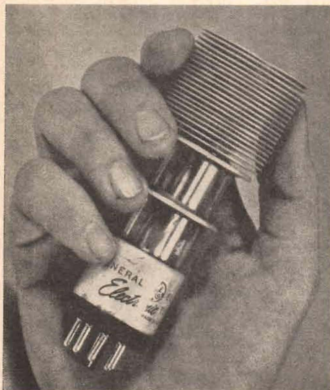
Fig. 2. »Lighthouse»-rör för UKV-apparater, användbart för frekvenser upp till och högre än 1 000 Mc/s. På anoden är påsatt en kylare. (Figuren är reproducerad ur FM, aug. 1944.)
