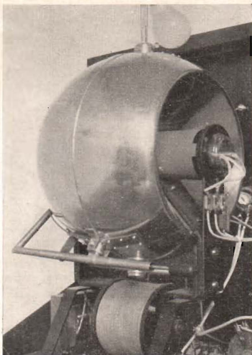
Fig. 5. Högfrekvensdelen sedd från rörets »anodsidan». Röret är till största delen skytt av fibercylindern. Munstycket för kyluftintaget synes bakom koaxialledaren, från vilken en manöverstång till kortslutningsbygeln sticker ut.
