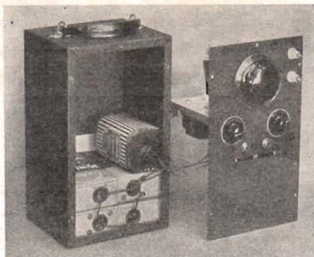
Fig. 16. En »transceiver» för 112 Mc/s med inbyggda batterier. (Ur QST, april 1940.)
