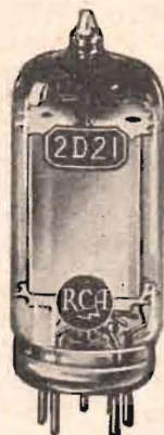
Fig. 7. Till vänster thyatron i miniatyrrutförande avbildad i naturlig storlek. Röret är en modern tetrod, fylld med xenongas. Typbeteckningen är 2D21 och rörets egenskaper påminna om den tidigare välkända thyatronen 2050. Till höger tvärsnittsbild av elektrodsystemet hos den äldre thyatronen 2050.
