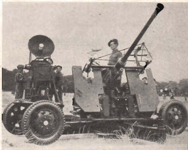
Fig. 9. Lätt luftvärnskanon av Bofors fabrikat avsedd för bekämpande av VI-bomber och försedd med eko-radiostation för inriktningen.
