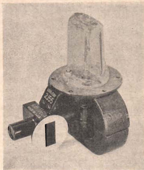
Fig. 3. Kompakt byggd magnetron; för 3,2 cm våglängd och 50 kW.
