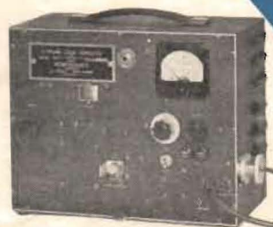
MODELL 78-B STANDARD SIGNALGENERATOR Två frekvensband mellan 15—250 Mp/s
