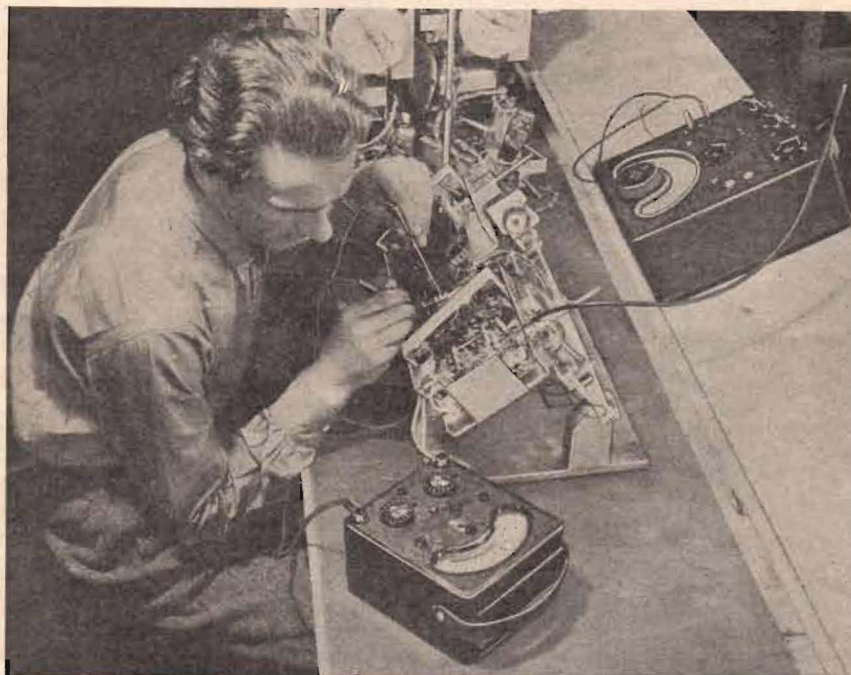
Felsökning på radiomottagare med tillhjälp av AVO-generator och AVO-meter modell 7.
