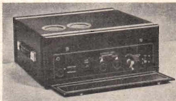
Fig. 5. Portabel Deccamottagare. Apparaten drives med 6 volts ackumulator och ett 120-volts torrbatteri. Faslagesindikatorerna enligt fig. 3 synes på översidan. Vikt: 15 kg.
