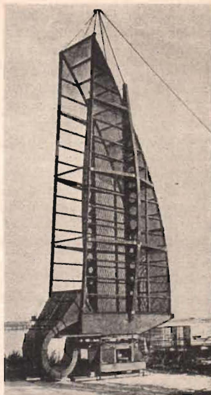
Fig. 1. Markbaserad stör- sändare avsedd att sätta flygburna ekoradioanlägg- ningar ur funk- tion.
