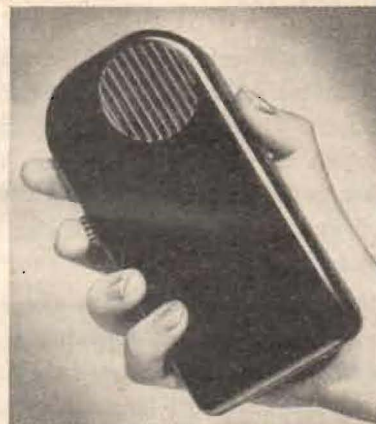
Fig. 5. Miniaturförstärkare med inbyggd mikrofon, avsedd för personer med nedsatt hörsel.
