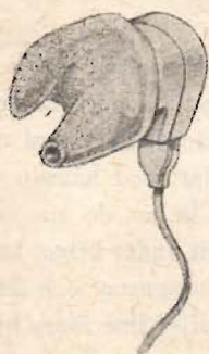
Fig. 8. T.v. Kristallhörteltelefon med hölje i form av öronmusslan, speciellt avsedd för dövhörningsapparater.
