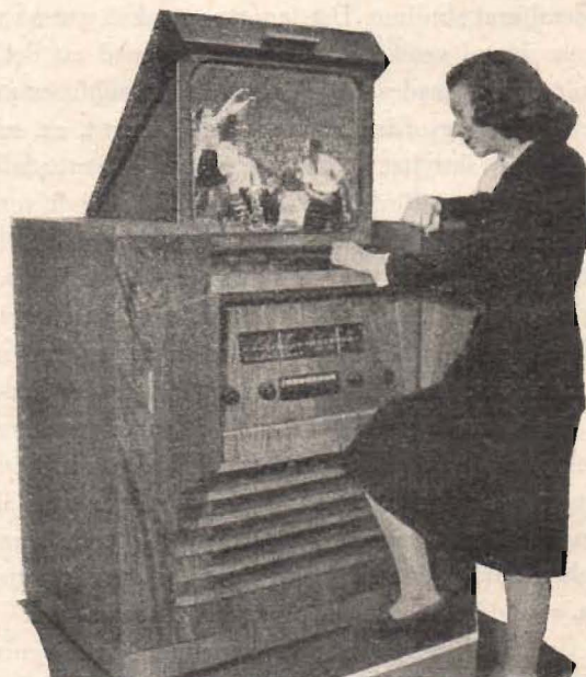
Fig. 13. Televisionsmottagare från HMV. Bilden projiceras på en skärm, storlek 40×50 cm.
