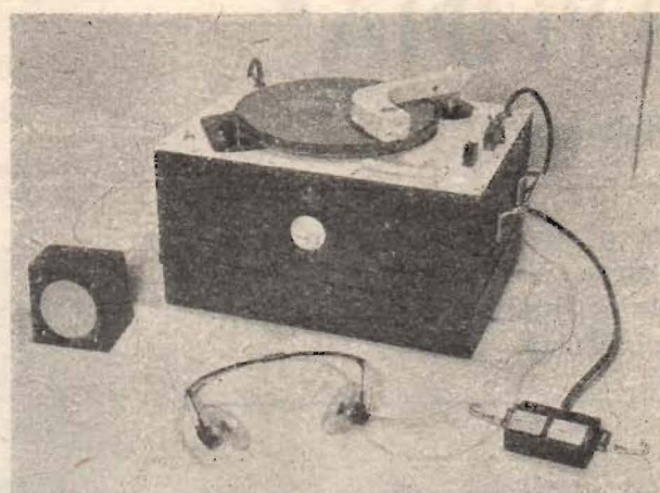
Fig. 7. Magnetisk plattinspelningsapparat för kontor (EMI).
