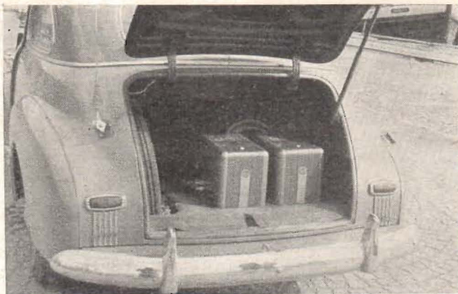
Fig. 1. 30 watts FM-station, fabrikerad RCA, inmonterad i en Chevrolet 47, som här är parkerad på Norr Mälarstrand. Anläggningen är så oöm att den vid en volt ut i terrängen, som denna bil var med om i vintras, icke sattes ur funktion eller tog någon skada. Observera den sidmonterade antennen till vänster.
