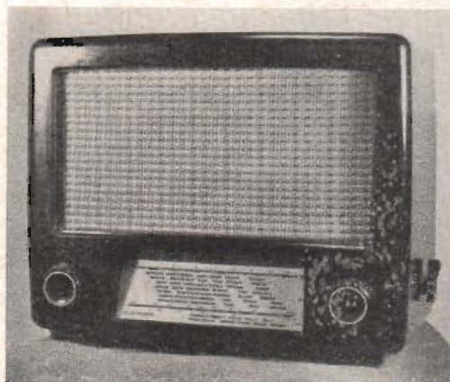
Fig. 2. Standardsuper från brittiska zonen. Mottagaren har 6 kretsar och 4 rör. Plasthölje.
