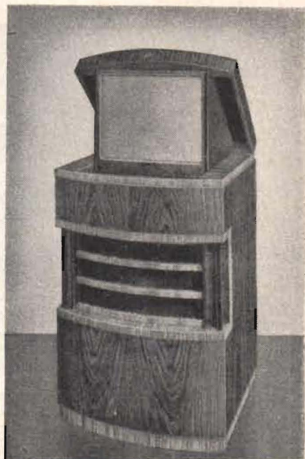
Fig. 5. Televisionsapparat med projektionssystem. Bildstorlek 33×41 cm. Apparaten innehåller 22 rör och har 3 1/2 W uteffekt. (Ferguson)
