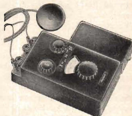
Fig. 12. Kapacitansbrygga från Hartmann & Braun.
