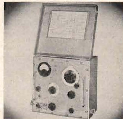
Fig. 3. Signalgenerator för mycket höga frekvenser från Advance. Frekvensområde 9,8 Mp/s—310 Mp/s.
