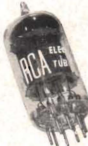
12AX7 Dubbeltriöd dim. likn. 12AU7 o. 12AT7
