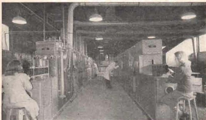
Fig. 1. Bilden visar de två flyglarna i ECME-maskinen. Flickorna i förgrunden sitter och matar in de på förhand på särskilt sätt preparerade plastplattorna på vilka är anbringade spår och fördjupningar, i vilka man genom sprutgjutning får fram ledningsförbindningar, induktanser och kapacitanser. Arbetarna i bakgrunden håller på med justeringar.
