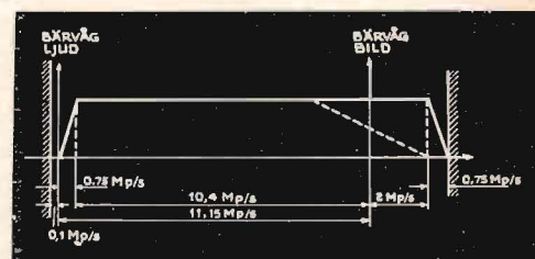
Fig. 6. Erforderlig bandbredd för en televisionssändare enligt de franska normerna.
