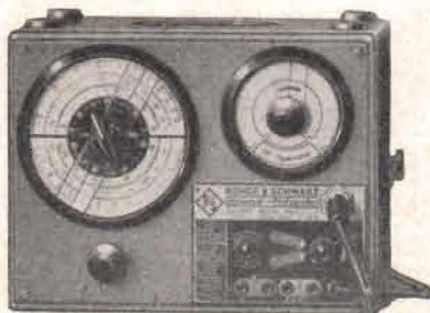
Fig. 5. Kombinationsinstrument för radioservice. Fabrikat Rodhe & Schwarz. Kan användas som signalgenerator, tonfrekvensoscillator, frekvensmeter m. m.
