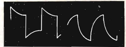
Fig. 2. (T. v.) Denna kurvform anger att grundtonen är mera dämpad än övertonerna. Dålig basåtergivning. (T. h.) Denna kurvform anger att övertonerna dämpas kraftigare än grundtonen. Dålig diskantåtergivning.
