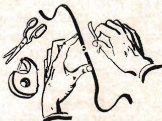
Fig. 1. Magnetofonband kan utan olägenhet skarvas med hjälp av en klisterremsa.
