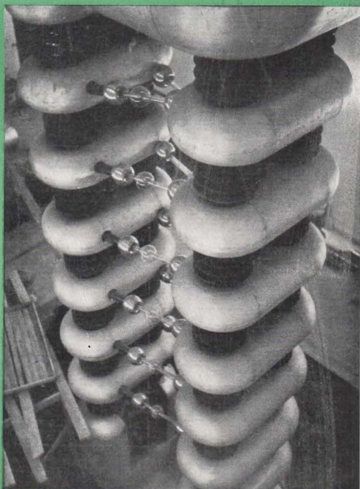
Kaskadgenerator som ger 1400 kV likspänning. Se artikel om svenskbyggd cyklotron på sidan 60
