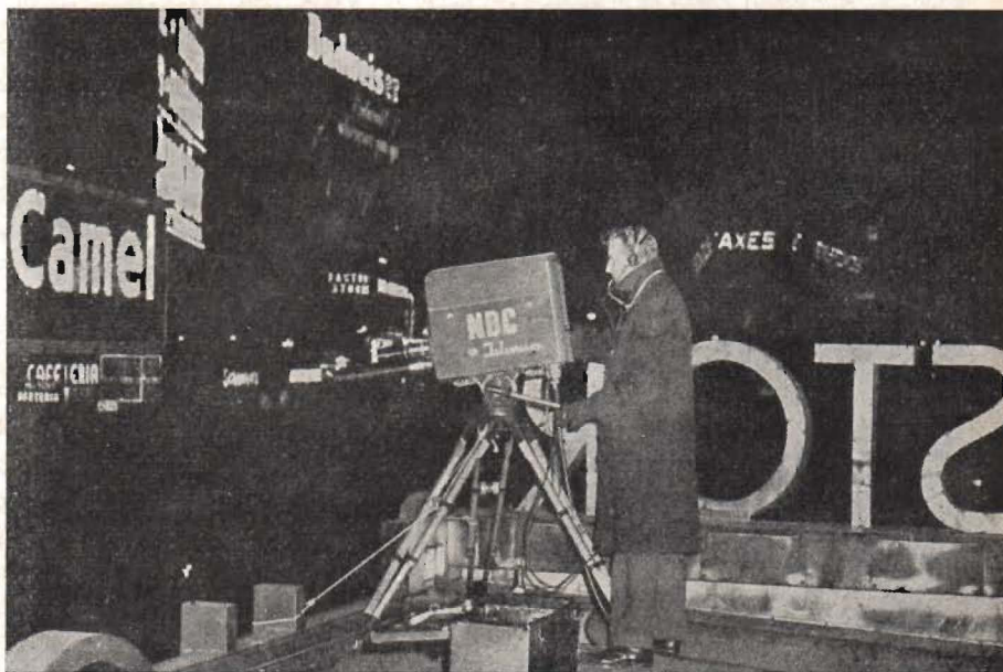
Fig. 6. Modern TV-kamera utrustad med RCA:s högkänsliga bildupptagningsrör 2P23 använd för upptagningar av nyårsfirandet. Trots att gatorna förefalla mörka kunde med framgång bilder av gatutrafiken och folklivet upptagas.
