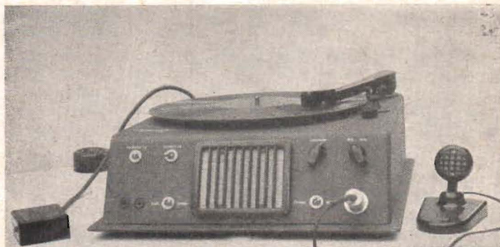
Fig. 3. Ny typ av diktafon av magnetofontyp. Plattan är preparerad med ett magnetiskt material. In- och avspelningshuvudets rörelser dirigeras genom spår i plattan.
