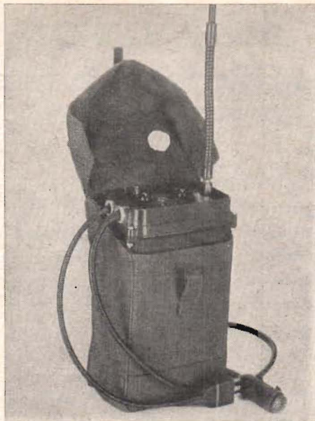
Fig. 7. Walkie-talkie från EKCO. Den är utrustad med 14 rör. Den kan användas för fyra alternativa frekvenser. Vikt ca 6 kg. Kristallkontroll och FM.
