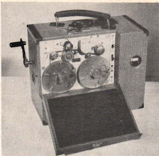
Fig. 2. Bärbar magnetofon vid NWDR. Vikt 15 kg. Som drivkraft användes ett fjäderverk, som arbetar 5 minuter utan förnyad uppdragning.
