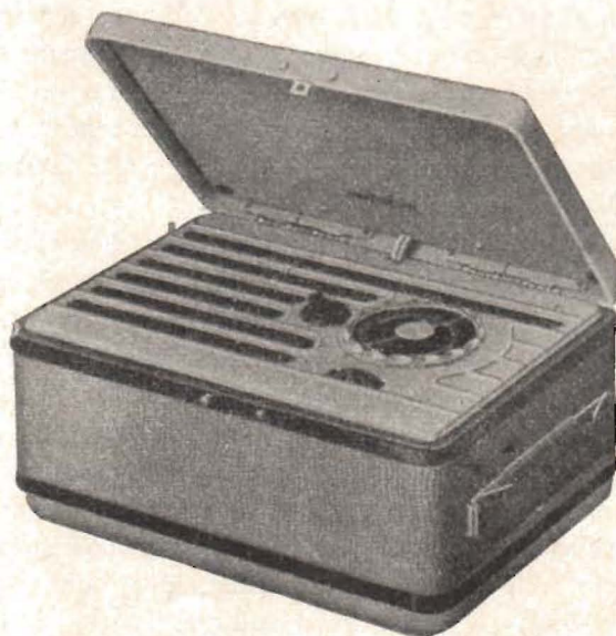
Fig. 4. 4-rörs reseradio. När locket fälls upp sättes apparaten i gång. Ramantenn är inbyggd i locket.
