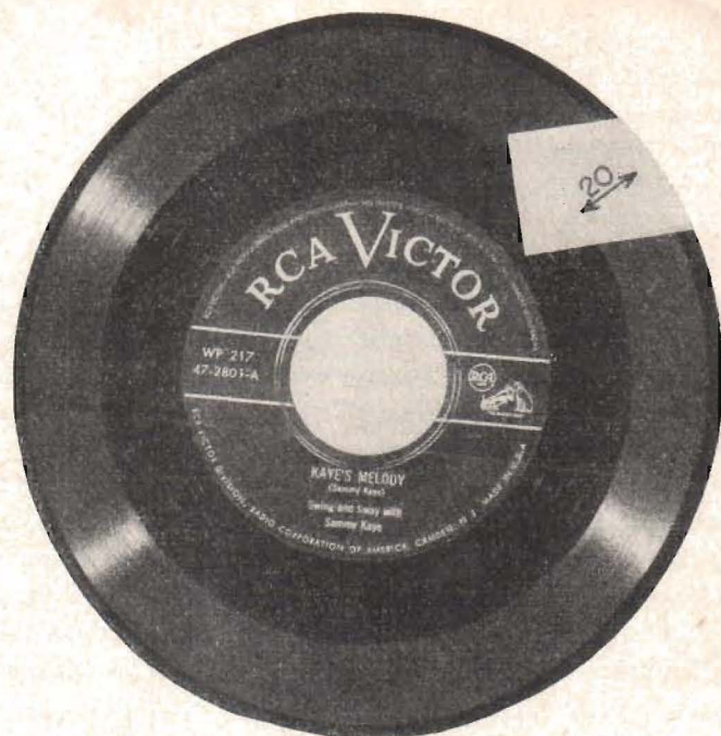
Fig. 4. Denna figur visar de nya LP-skivorna från RCA i halv skala. Skivorna är graverade endast över en 20 mm bredd på skivan, varigenom man kommer ifrån viss distortion vid avspelningen.
