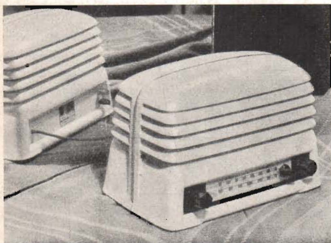
Fig. 1. Trevlig rundradiomottagare med hölje bestående av två exakt lika halvor av plast.
